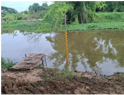
รูปที่ 2-29 การติดตั้งเสาวัดระดับในแม่น้ำกวัง
